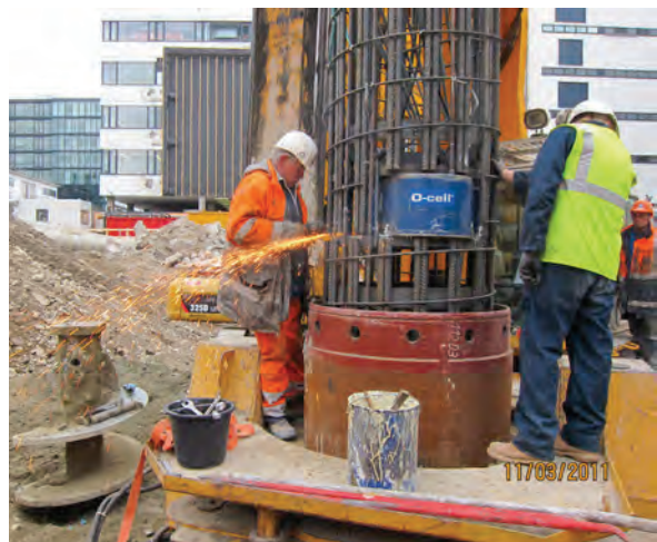
Bild 2 Ausführung von statischen Pfahlbelastungsversuchen in Basel (links: klassische Methode mit Ankern als Widerlager für die Nordtangente, rechts: Osterberg-Methode für Roche Bau 1)
