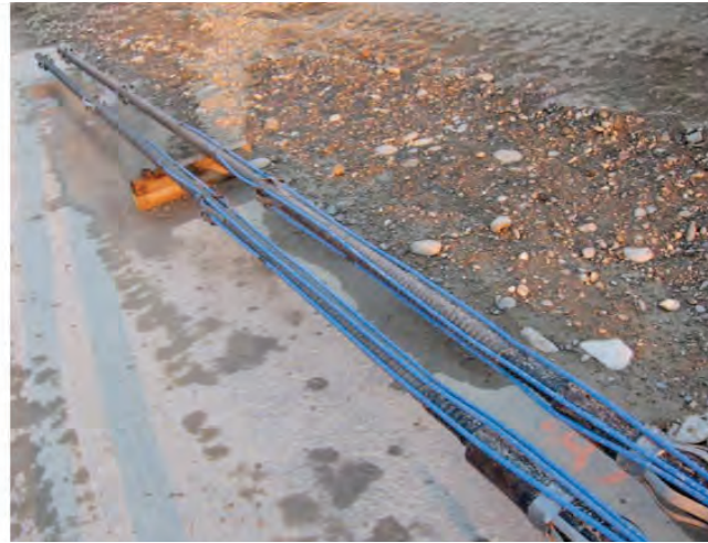
Bild 3 Versuchsmikropfahl (links: Mikropfahl mit Injektionsschläuchen (blau) und Freispülschläuchen (gelb) rechts: Detail Verankerungsstrecke mit Injektionsschläuchen)
