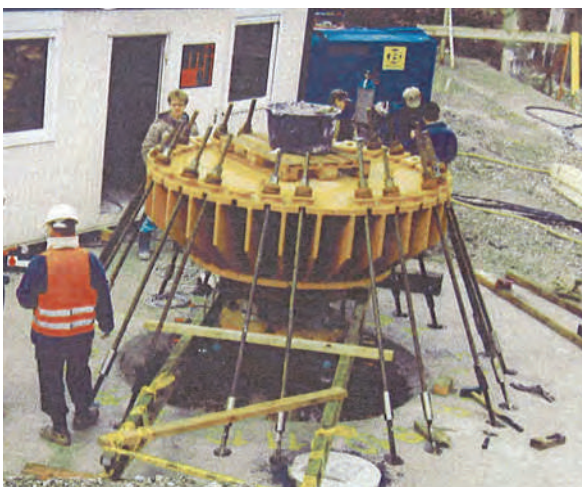
Bild 2 Ausführung von statischen Pfahlbelastungsversuchen in Basel (links: klassische Methode mit Ankern als Widerlager für die Nordtangente, rechts: Osterberg-Methode für Roche Bau 1)
